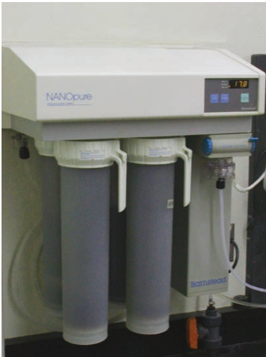
Sistema de remoción (o eliminación) de iones adecuada para el uso en laboratorio que utiliza cuatro filtros de resina de lecho mixtos y filtros de carbón activado y de partículas.
